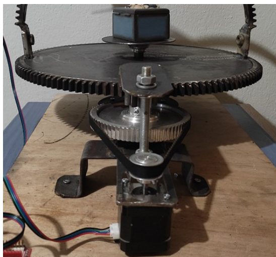
Εικόνα 4: Μηχανισμός κίνησης άξονα X
